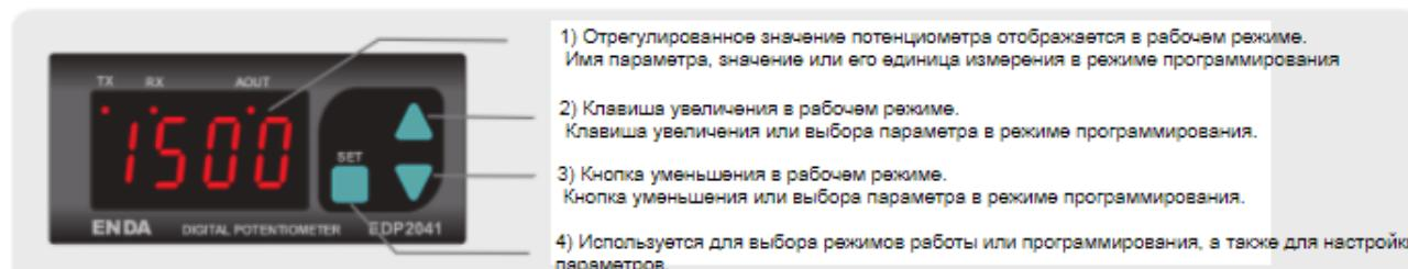
(1) Цифровой дисплей 12,5 мм 4 цифры 7-сегментный красный светодиодный дисплей
